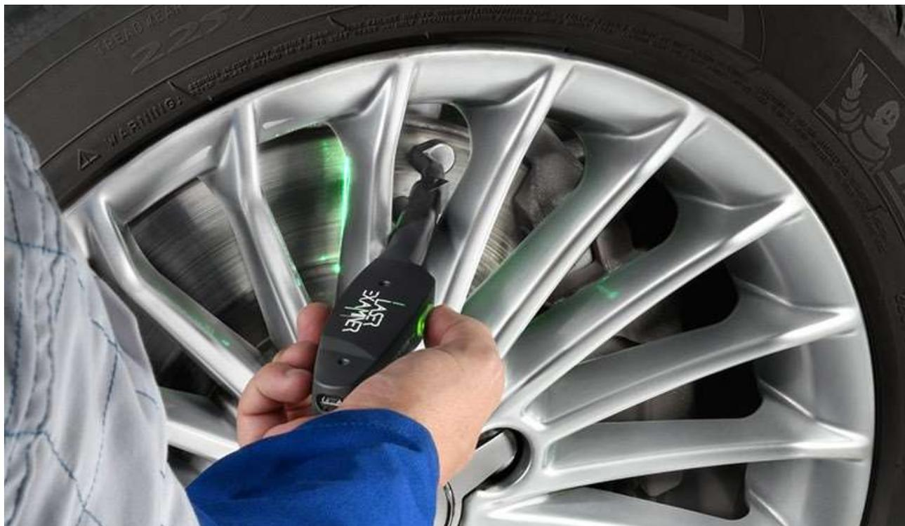
LASER EXAMINER è uno strumento di misura **pratico e di piccole dimensioni**, che consente di rilevare, con una precisione al decimo di millimetro ed in maniera oggettiva, il **consumo del disco freno** dei veicoli, senza dover smontare la ruota. È inoltre possibile misurare, utilizzando un semplice adattatore, l'**usura del battistrada** degli pneumatici.
