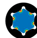
LA PARTICOLARE FORMA DELLE IMPRONTE SONIC PERMETTE IL PERFETTO ACCOPPIAMENTO E LA TRASMISSIONE DI TUTTA LA FORZA SU DADI E BULLONI SENZA ROVINARE LA SUPERFICIE. DANNEGGIARE GLI ANGOLI DEL BULLONE NON È PIÙ UN RISCHIO.
