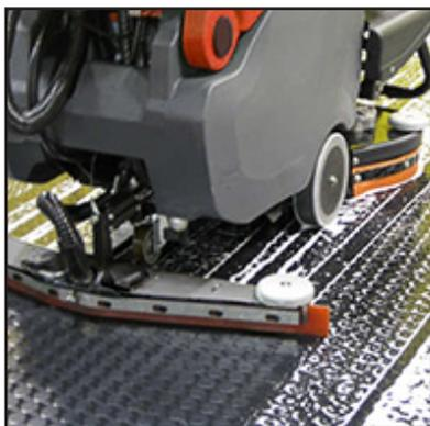
Esclusivo sistema di tergilavaggio che assicura alte prestazioni e bassi costi. La forma a V permette di raccogliere tutta l'acqua ed assicura un'asciugatura Incomparabile su superfici di massima difficoltà
