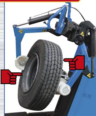
Gli stallonatori sono supportati da due bracci comandati separatamente. Ogni braccio ha due rulli stallonatori, uno conico che spinge sul tallone, e uno cilindrico che spinge la spalla del pneumatico.
