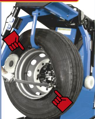
La macchina è anche fornita di una leva brevettata che facilita il montaggio/smontaggio del pneumatico. Questa leva elimina quelle pinze ingombranti comunemente necessarie nelle macchine prodotte sino ad oggi.
