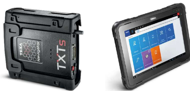
Fig. 2: A sinistra: componente hardware di misura NAVIGATOR, a destra: componente hardware HMI AXONE con installato il software IDC5
