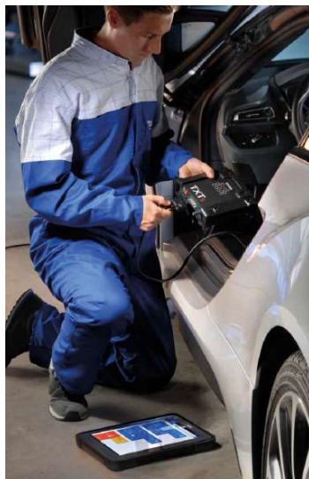
Fig. 3: Utilizzo del sistema di autodiagnosi composto da NAVIGATOR + software IDC5 installato su AXONE
