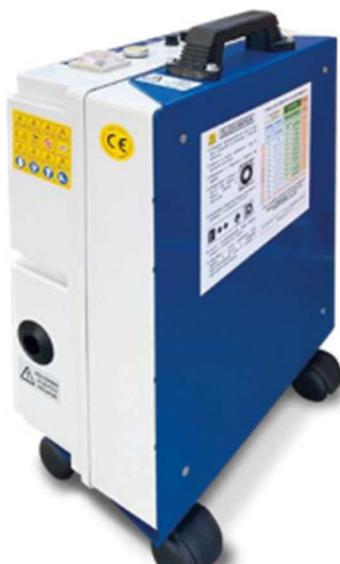
GERM OZONE 7 è dotato di sistema Tubolare al Quarzo. Particolari tubi con scarica a corona provvedono alla produzione di una miscela gassosa di alta qualità, che consente di raggiungere un'elevata efficacia nel trattamento dell'ambiente e una produzione bassa di composti azotati ( NOx e NO2 ) dannosi per la salute rispetto ai sistemi a piastre ceramica.
